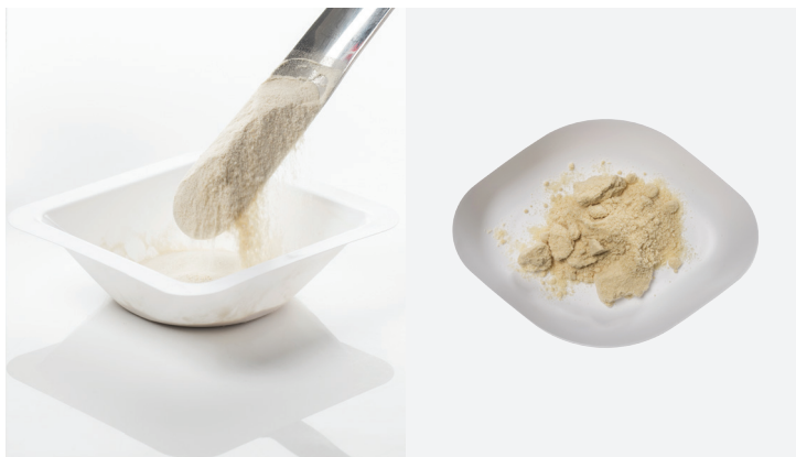
Figura 3. Compruebe que los productos empleados en la preparación de los medios de cultivo se almacenen según las condiciones especificadas por el fabricante. De este modo se evita el deterioro, por ejemplo, el provocado por la humedad, como se muestra en la imagen de la derecha.
