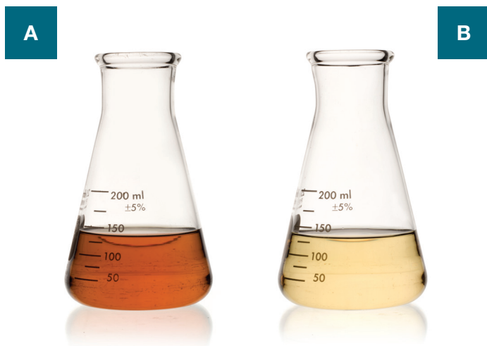
Figura 4. A: medio sobrecalentado. Color oscuro, pH bajo que provoca una reducción del crecimiento de microorganismos de cultivo exigente. B: medio correctamente esterilizado, con un color más claro.
